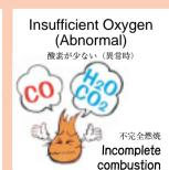
Toxic CO is produced through incomplete combustion. 不完全燃焼を起こし、有害なCOが 発生します。
